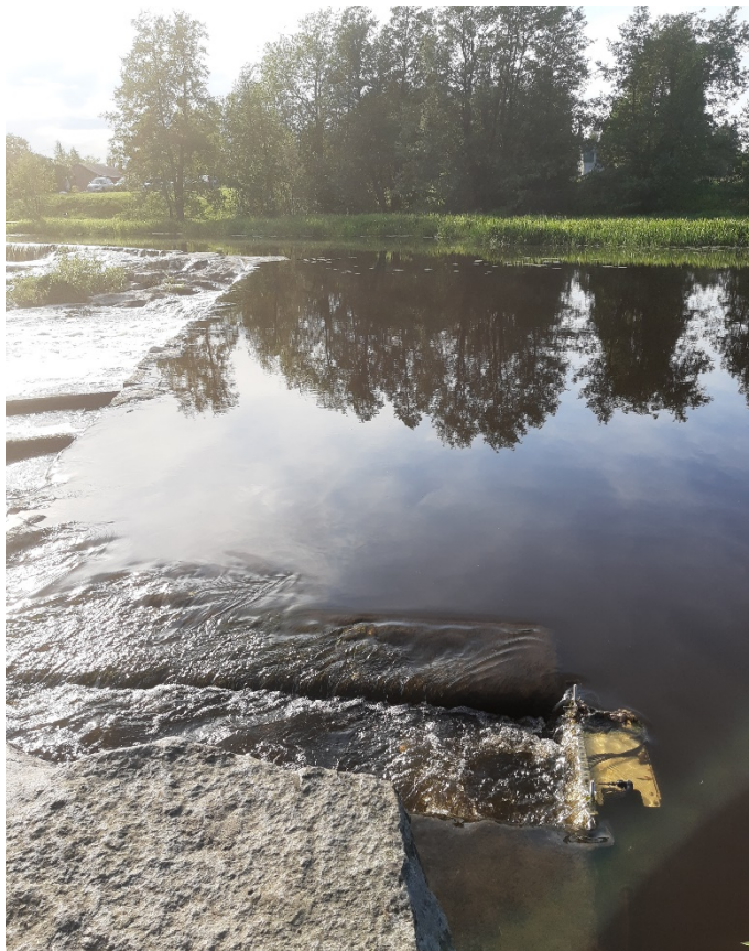
Kuva 8. Kalalaskuri asennettuna Kirkonkylänkosken kalatiehen kesäkuussa 2021.
